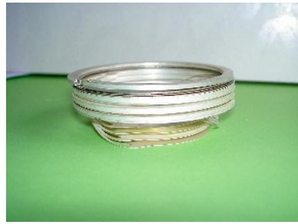
Deux façons de monter les ressorts. L'anneau extérieur est solidaire de l'attelage mobile, et l'anneau intérieur du bâti (cylindre axial). Des rondelles cylindriques séparent les lames. La photo du haut montre une lame dans chacune des 2 configurations de montage, les deux photos du bas montrent les ressorts complets. La raideur de l'ensemble est fonction du sens de montage (plus grande dans le cas de gauche).
